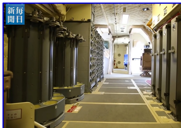
A DX - Il sistema di lancio delle sonoboe (primo piano a sx), lanciatori manuali (a dx) e rack per le sonoboe (secondo piano a sx).
